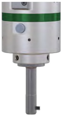
SOLO2 - 低切削速度需求。刀片在静止状态下(主轴停止)伸出。该刀具的最高加工工作速度为 1500 rpm。刀片收回刀片壳的工作速度需大于 1900 rpm。
