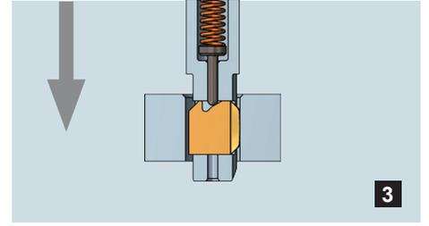
正面倒角加工完成，刀片完全进入刀体后，刀具可快速通过工件而无需主轴停转。
