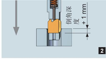
正向攻进加工正面倒角至倒角深度加1mm处，此时刀片完全收回刀体内。
