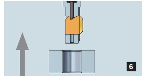
刀具快速移出工件，正反倒角加工完成。
