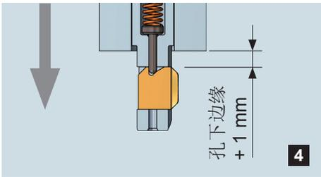
快进至背面切削刃离孔下缘1mm处，刀片弹出，开始加工背面倒角。
