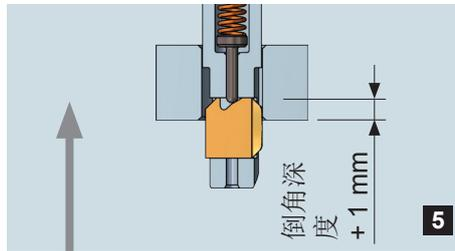
反向攻进至倒角深度加1mm处，背面倒角完成。
