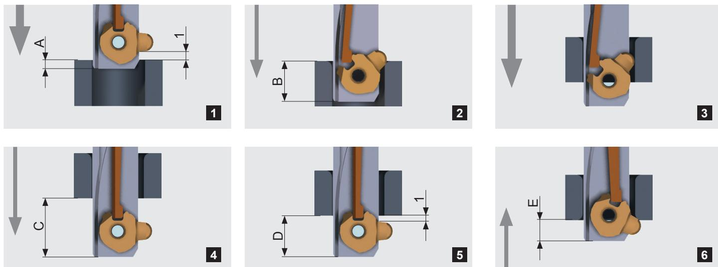
1. 快速将刀具移至工件孔口上方。可以参考刀杆端部离孔口的距离A。
