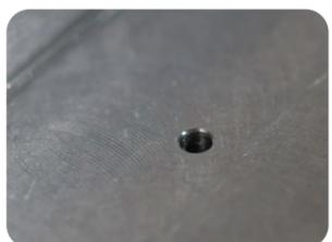
使用涂层硬质合金刀片可确保完全断刃 - 刃口无毛刺。
