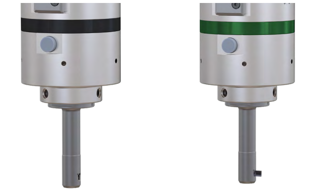
SOLO - 高切削速度需求。刀片在静止状态下(主轴停止)收回。它的最低运行工作速度为 1900 rpm。只有超过最低工作速度后，刀片才会伸展到工作位置。通过停止主轴来收回刀片。
